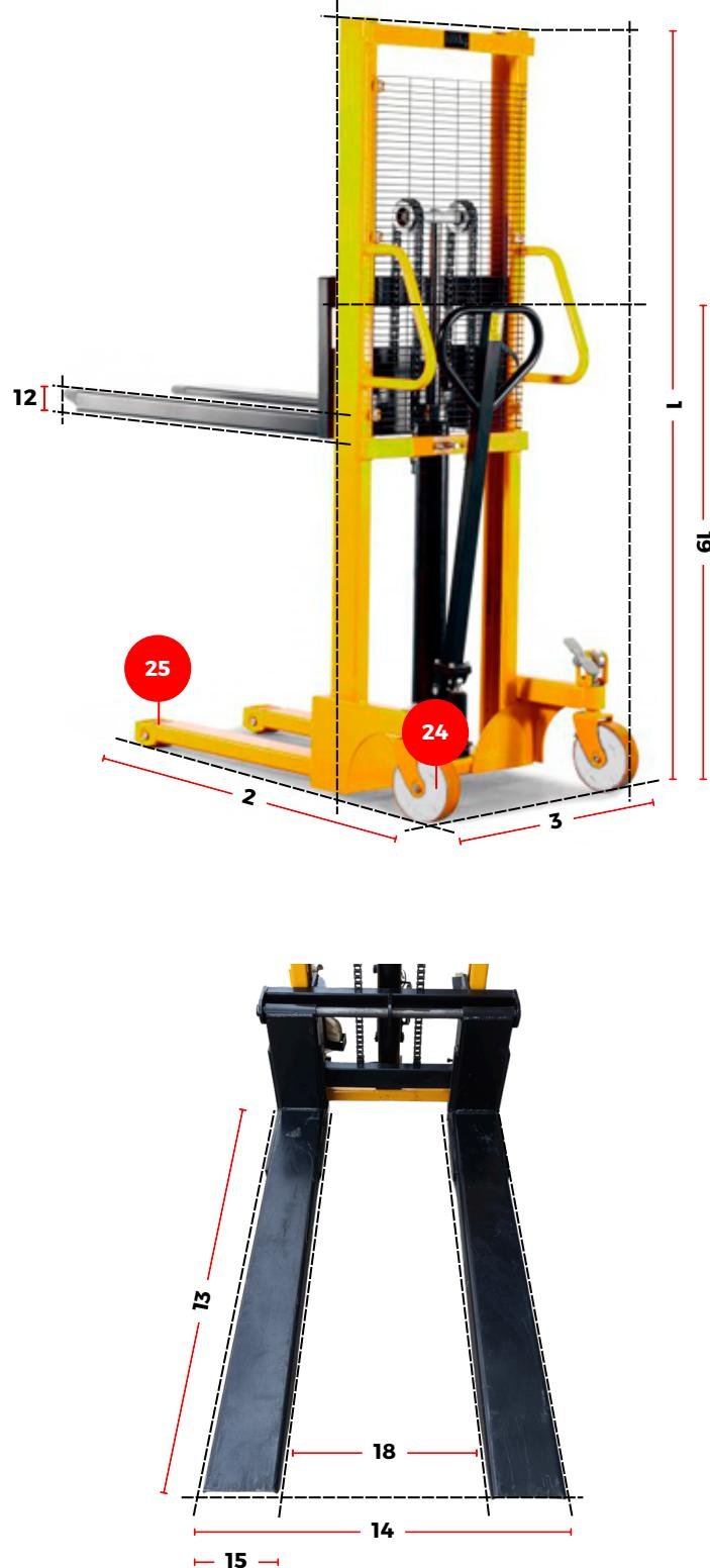
Diseñado para el manejo eficiente de carga, este apilador manual soporta hasta 1000 kg y eleva hasta 1,6 metros. Su estructura de acero resistente garantiza durabilidad en entornos industriales exigentes.
