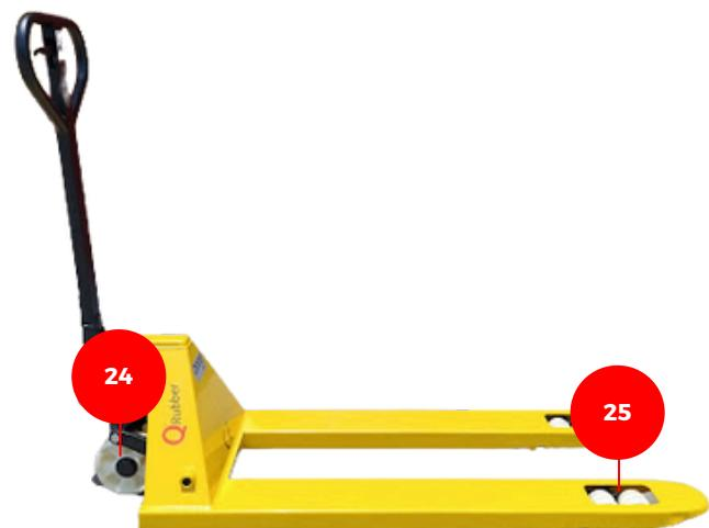
iseñada para el manejo eficiente de cargas pesadas, esta transpaleta soporta desde 2 hasta 3 toneladas . Su estructura de acero resistente garantiza durabilidad en entornos exigentes.
